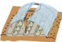
狭幅フィルムを2枚合わせて掛け、頂部を開き換気する
