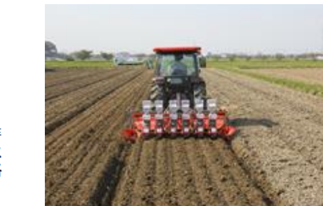
幅3m以内の排水溝の設置（は種時）
