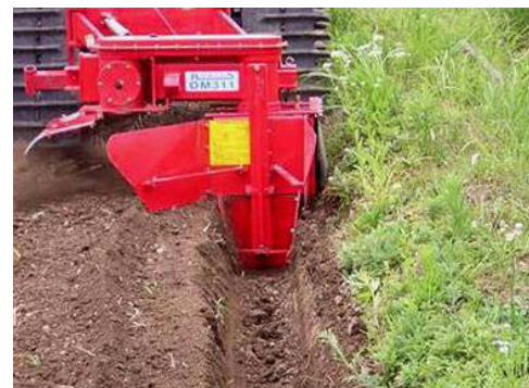
トラクターによる額縁排水溝の設置
