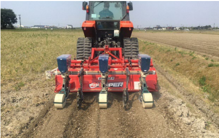
アップカットロータリーによる 耕うん同時うね立て播種
